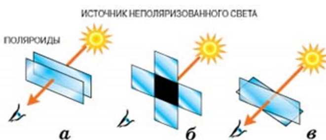
Рис. 114. Свет проходит через систему из двух поляроидов: а – когда они параллельны; б – скрещены; в – расположены под произвольным углом
