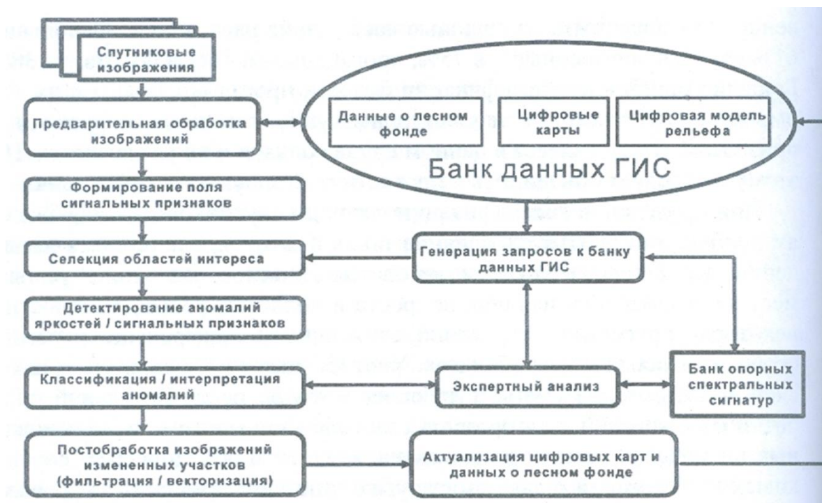
Рис. 142. Схема основных положений актуализации данных о лесном фонде с использованием спутниковых изображений и ГИС
