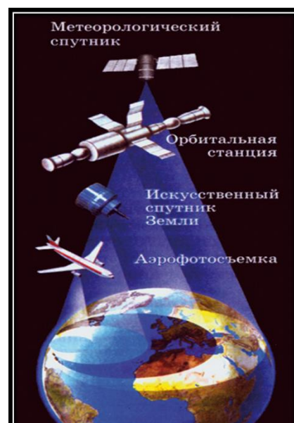
Рис. 39. Сравнение высоты и диапазона покрытия при съемке различными способами
