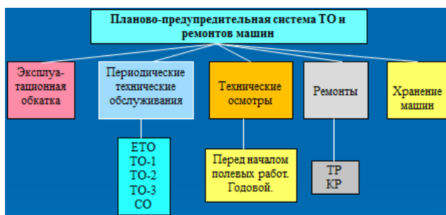
Рис.4.3. Элементы планово-предупредительной системы ТО машин
