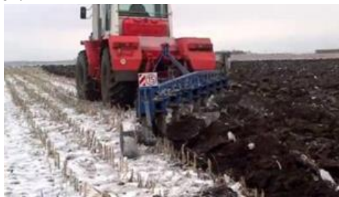
Рис. 2.3. МТА для отвальной вспашки зяби
