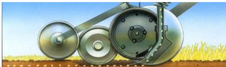
Рис. 2.11. Технологическая схема прямого посева зерновых
