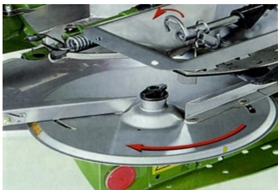
Рис. 3.2 Центробежный диск для разбрасывания минеральных удобрений
