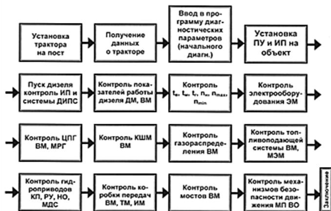
Рис. 4.10. Технология диагностирования машины
