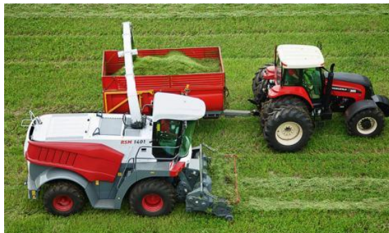
Рис. 3.19 Кормоуборочный комбайн РСМ-1401 на подборе валков
