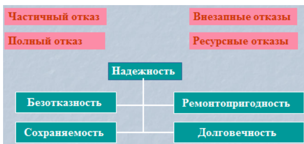
Рис. 4.1 Виды отказов и свойств машины
