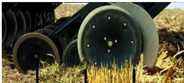
Рис. 2.12. Рабочие органы сеялки для прямого посева зерновых
