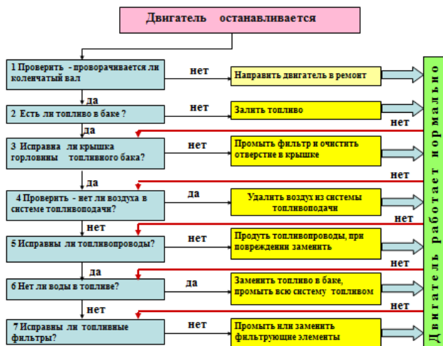
Рис. 4.11. Последовательность диагностирования ДВС
