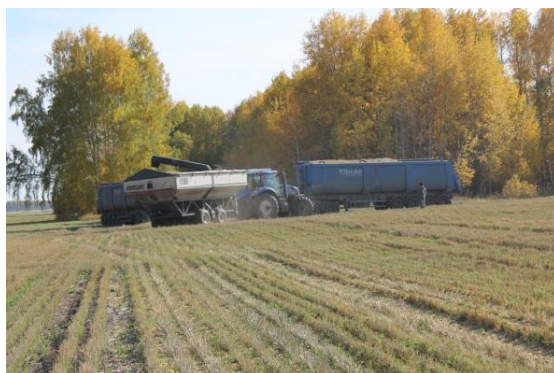
Рис. 5.8. Перегрузочная технология с использованием прицепов-перегрузателей
