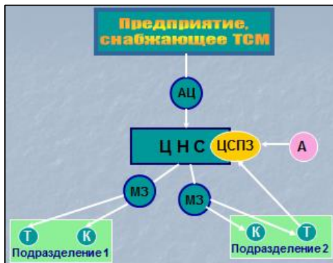
Рис. 5.13 Схема централизованного способа заправки машин
