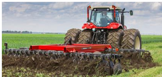
Рис. 2.7. МТА для дискования почвы
