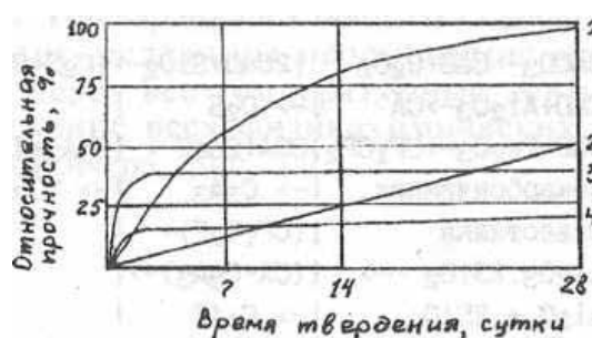
Рис. 3.1. Скорость твердения клинкерных минералов в нормальных условиях: 1 – C_3S ; 2 – C_2S ; 3 – C_3A ; 4 – C_4AF
