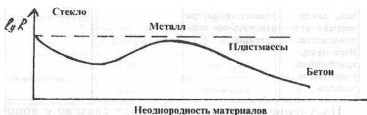
Рис. 4.11. Влияние неоднородности на прочность
