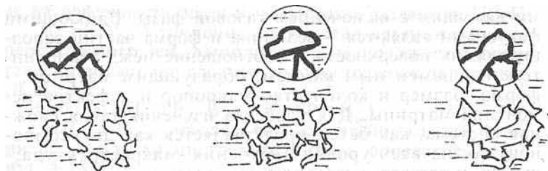
Рис. 4.10. Основные типы контактов между частицами в дисперсных системах (по П. А. Ребиндеру)
