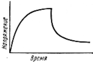
Рис. 1.14. Релаксация напряжений при постоянной деформации
