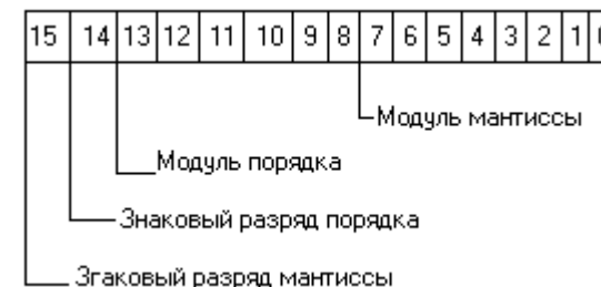
Рис.9.6. Формат слова данных с плавающей запятой
