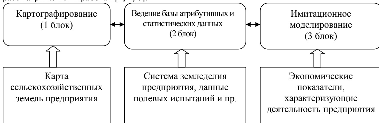
Рис. 1 – Структура программно-технологического комплекса для управления производством продукции растениеводства
