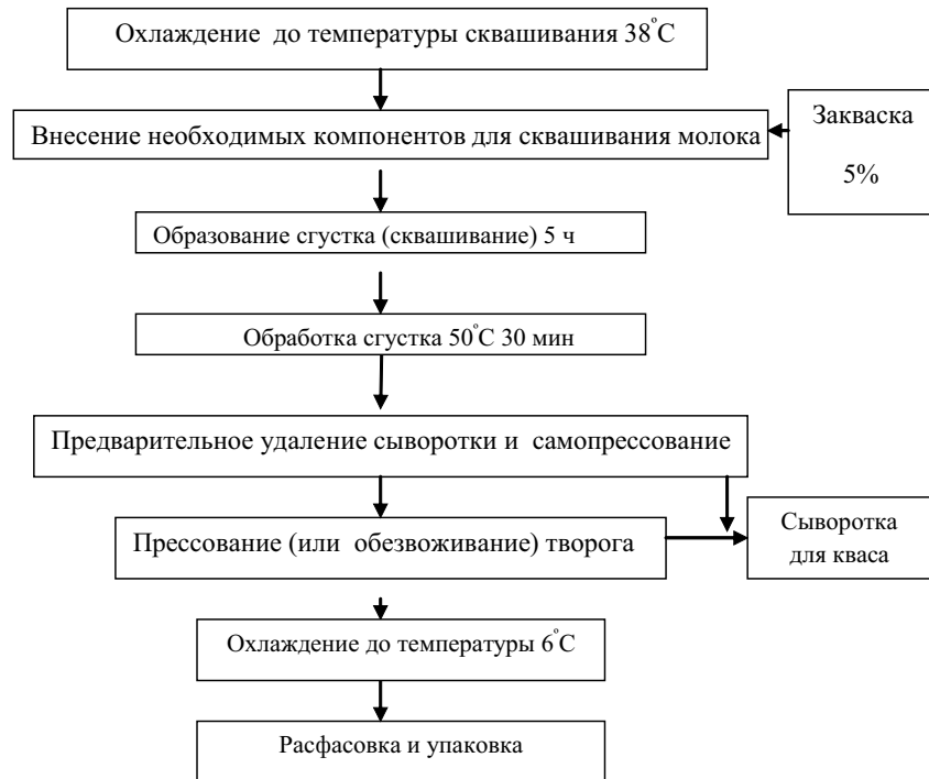
Схема получения нового вида творога из соевого молока с использованием штаммов Lactobacterium helveticum и Streptococcus salivarius
