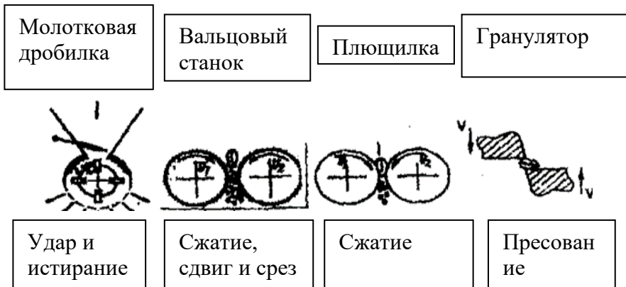
Рисунок 1 - Вид воздействия рабочих органов на зерно
