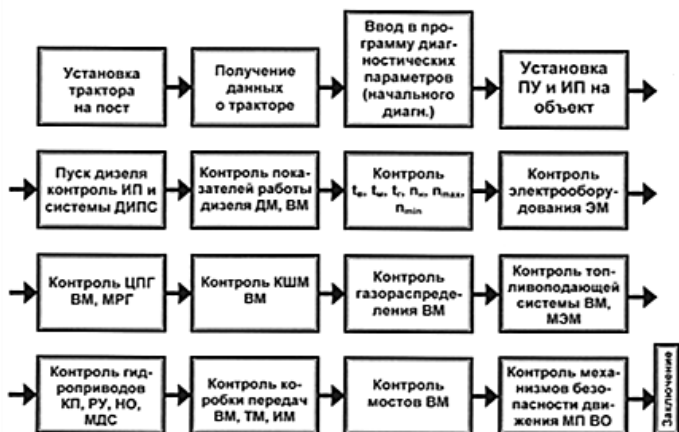
Рис.4.9 Технология диагностирования машины
