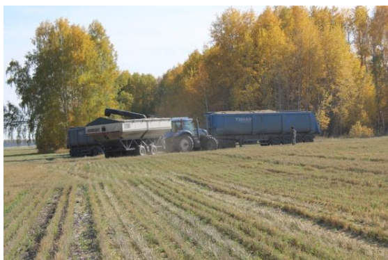
Рис. 5.8 Перезрузочная технология с использованием прицепов-перезружателей
