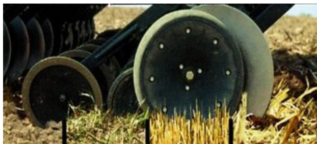
Рис. 2.13 Рабочие органы сеялки для прямого посева зерновых
