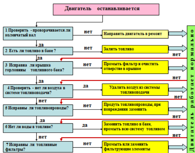
Рис.4.10 Последовательность диагностирования ДВС
