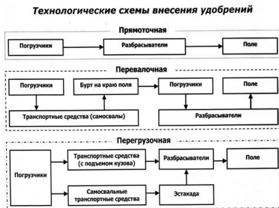
Рис. 3.1 Технологические схемы внесения удобрений
