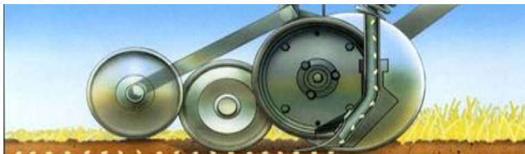
Рис. 2.12 Технологическая схема прямого посева зерновых
