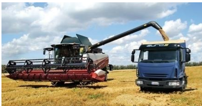
Рис. 5.5 Обслуживание комбайнов по схеме прямоточных перевозок
