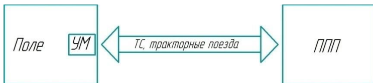
Рис. 5.6 Транспортное обслуживание по схеме прямоточных перевозок
