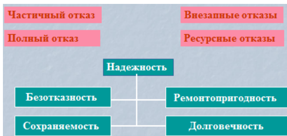
Рис. 4.1 Виды отказов и свойств машины
