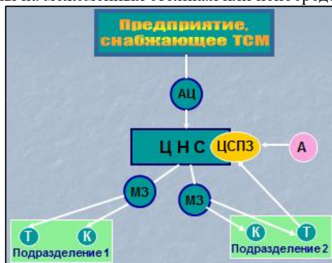
Рис. 5.13 Схема централизованного способа заправки машин
