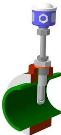
Рисунок 2.2.7 - Монтаж термометра сопротивления на трубопроводе
