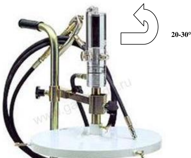
Рисунок 5.3 Удаление воздуха из бака
