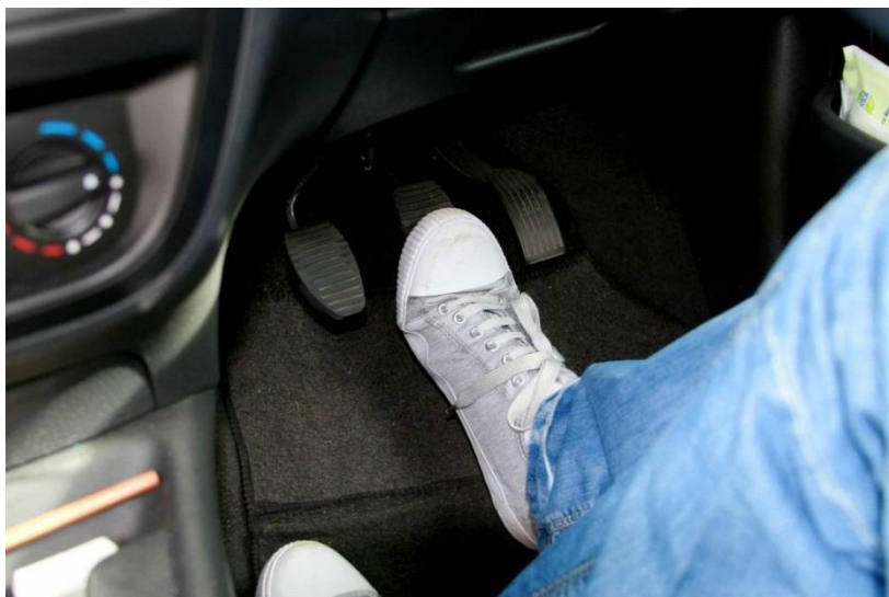
Рисунок 6.10 Сброс остаточного разряжения из вакуумного тормозного усилителя
