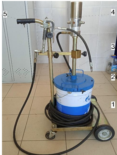
Рисунок 5.1 – Нагнетатель густых смазок пневматический RAASM
