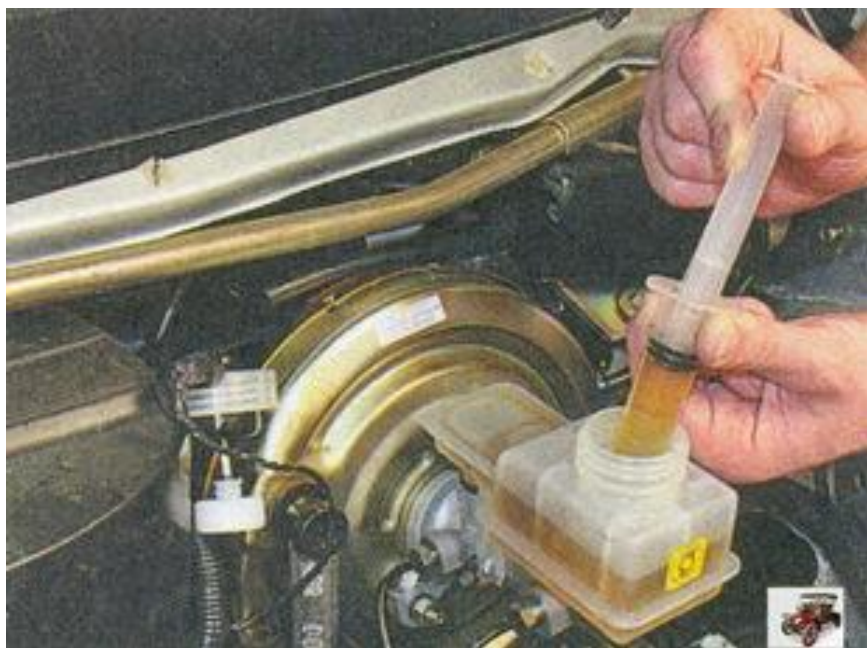
Рисунок 6.9 Частична замена тормозной жидкости
