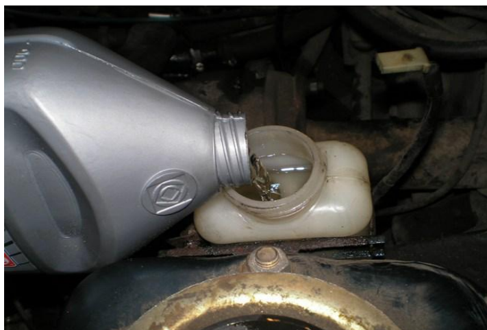
Рисунок 6.17 Восстановление уровня тормозной жидкости до штатного
