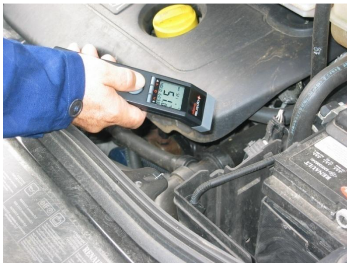
Рисунок 6.4 Проверка температуры двигателя
