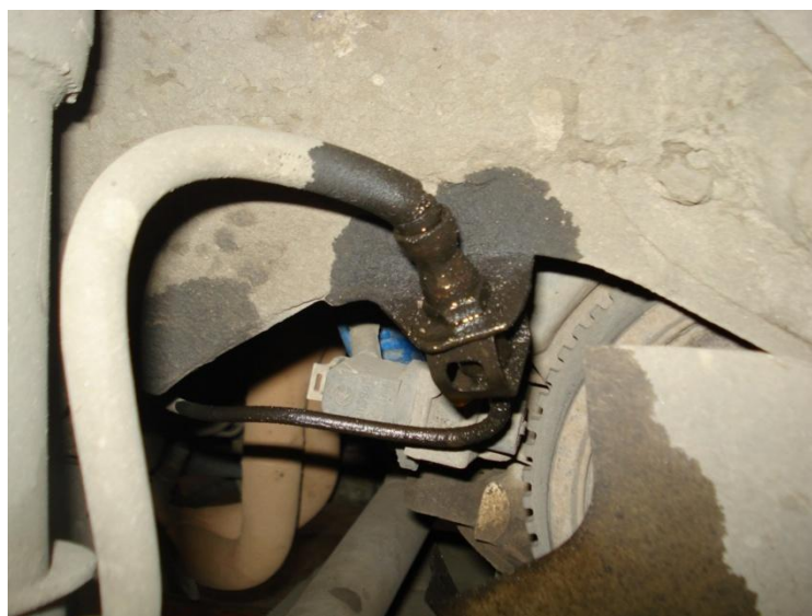
Рисунок 6.3 Повреждение тормозного шланга
