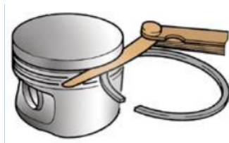
Рис. 3. Измерение щупом действительного зазора между канавками в поршне и кольцами
