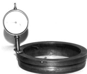
Рис. 12. Приспособление для контроля износа посадочного буртика под гильзу цилиндров
