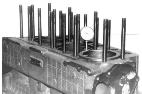
Рис. 13. Определение величины проседания бутика под гильзу с помощью индикаторной головки
