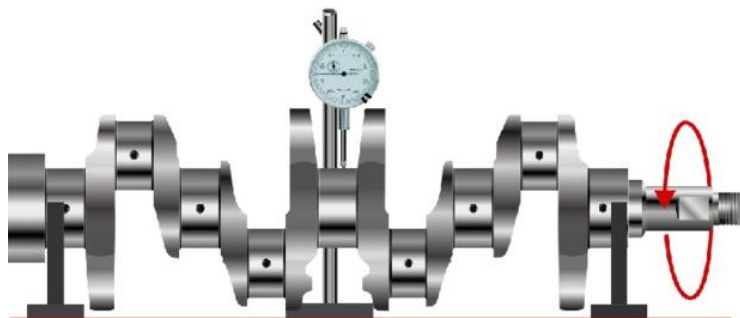
Рис.8. Схема определения радиального биения коленчатого вала.
