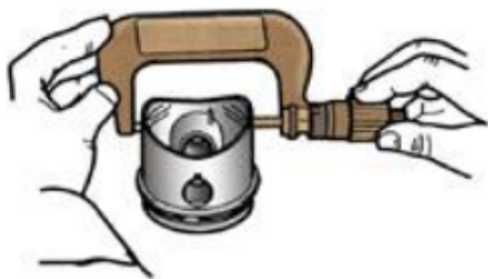
Рис. 2. Измерение микрометром диаметра юбки поршня
