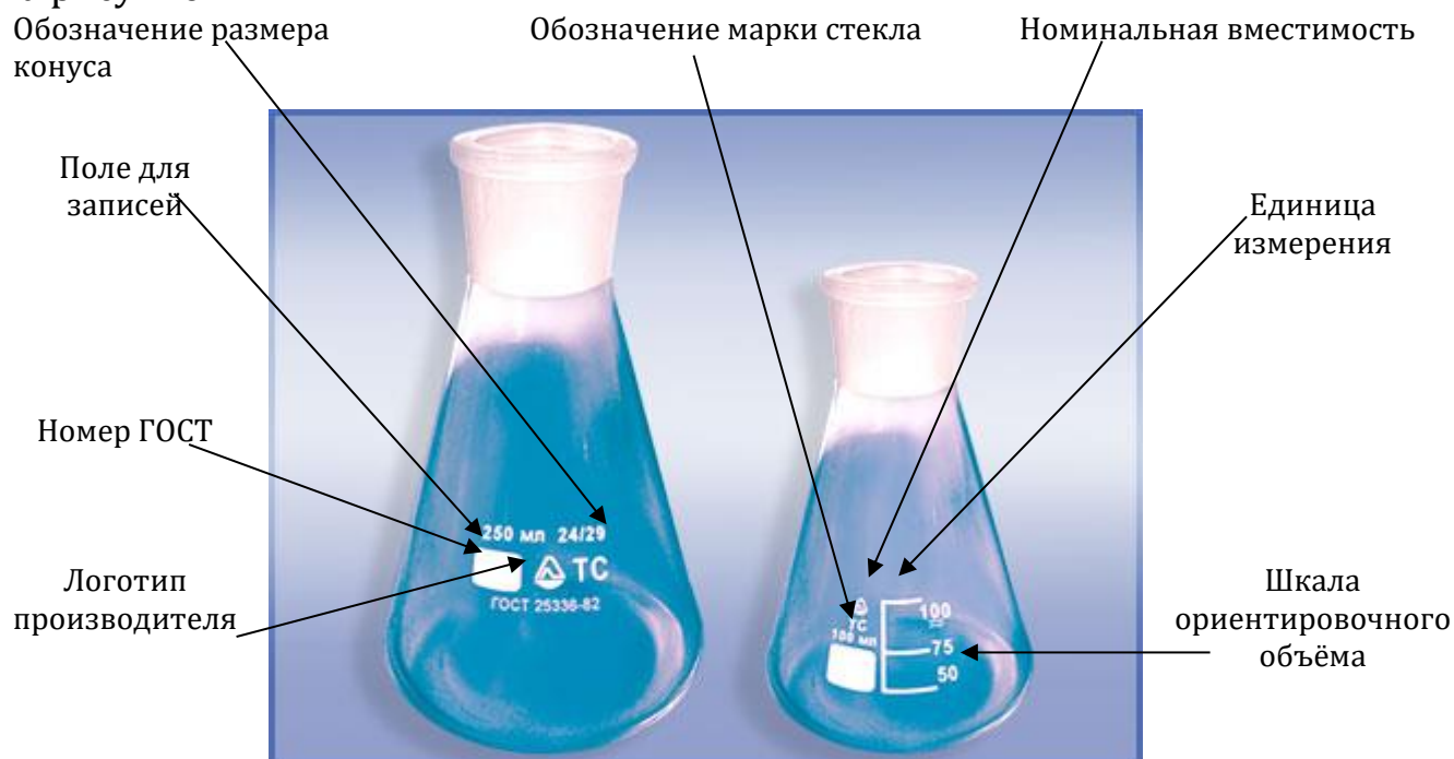
Рисунок 1. Нанесение маркировки на изделия общего назначения из стекла на примере колбы конической типа Кн.
