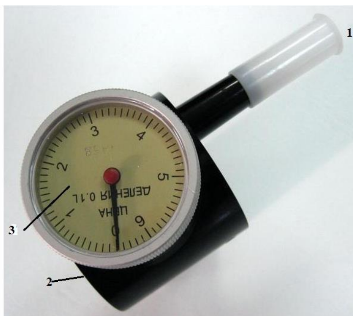
Рис. 1. Суховоздушный спирометр ССП (стрелкой показано направление движения воздуха)
