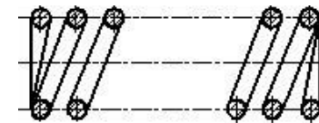
Рис. 63 - Продольный разрез пружины
