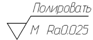
Рис. 43 - Обозначение шероховатости поверхности с видом обработки
