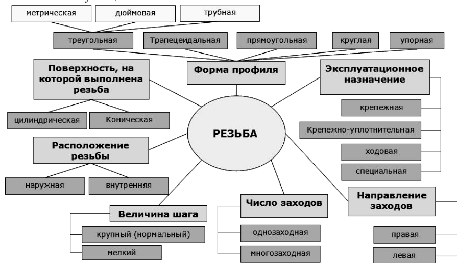
Рис. 105 - Классификация резьб
