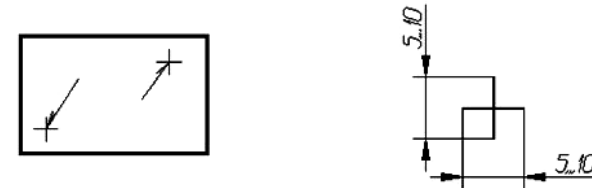
Рис. 139 - Обозначение сварных точек
