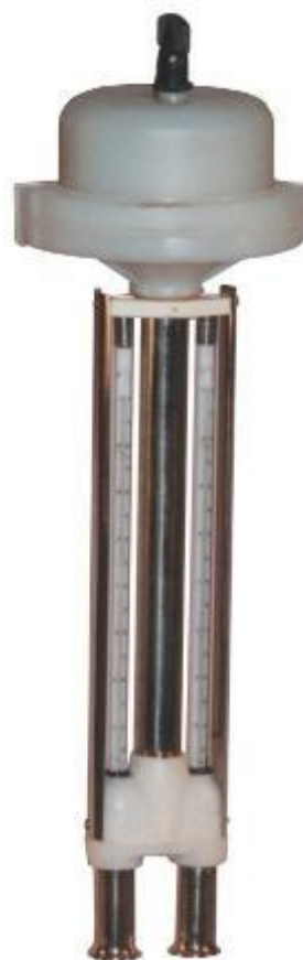
Рис. 21. Аспирационный (динамический) психрометр (Ассмана) MB-4M
