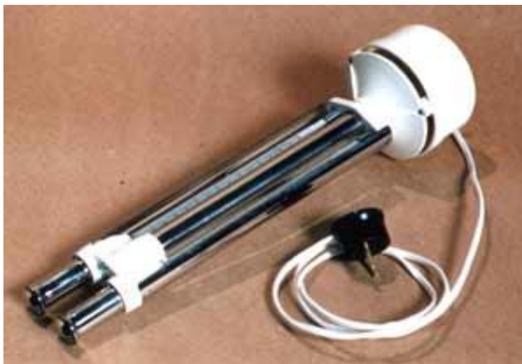
Рис. 22. Психрометр электрический М-34М
