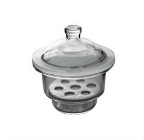
Рис. 20. Эксикаторы: а – обычный, б – вакуумный
