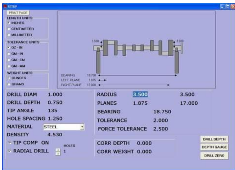
Рис. 2. Ввод данных по коленчатому валу в компьютер балансировочного станка
