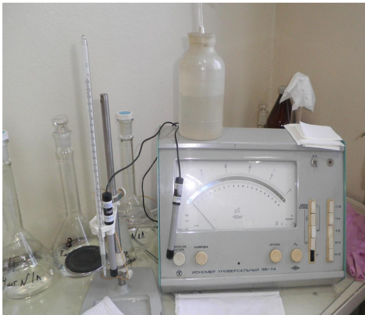
Рис. 17. Иономер ЭВ-74 для измерения концентрации нитрат-ионов
