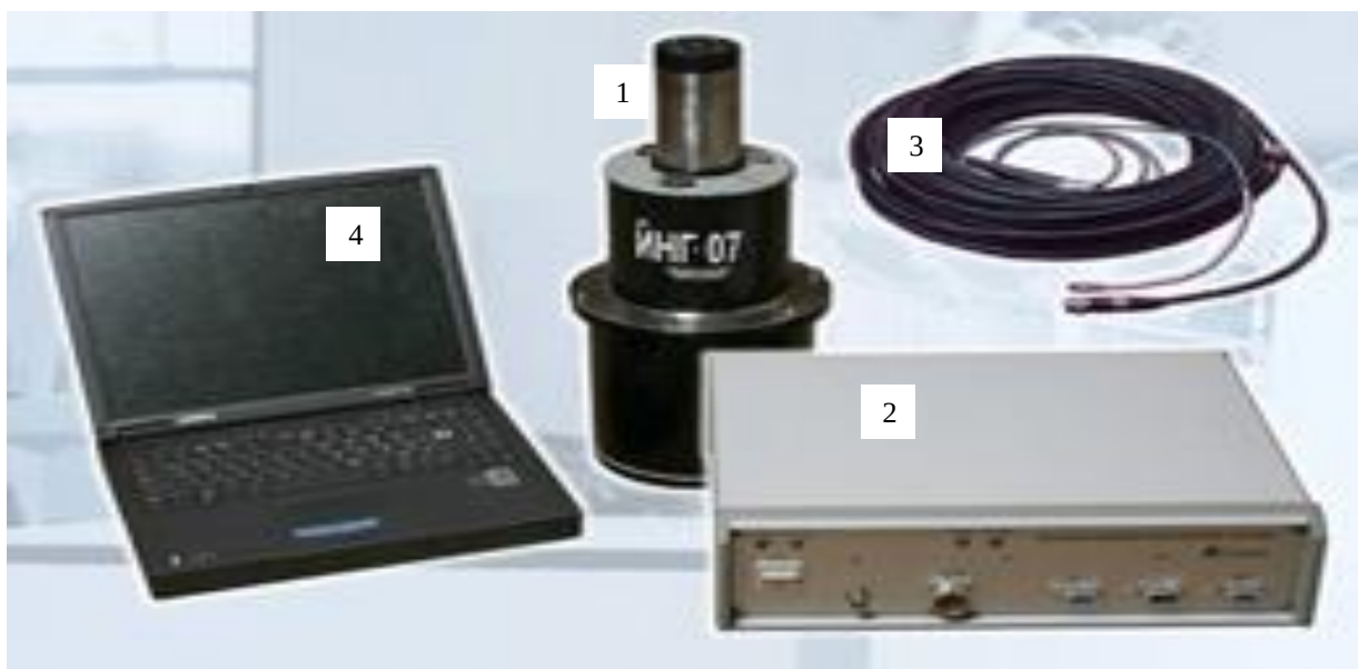
Рис. 34. Импульсный нейтронный генератор на газонаполненной трубке для аппаратуры активационного анализа ИНГ – 07: 1 – излучатель нейтронов; 2 – устройство питания; 3 – комплект соединительных кабелей; 4 – ЭВМ
